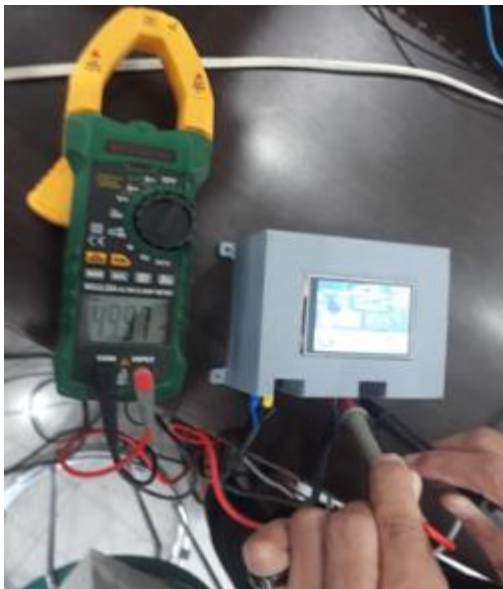
Gambar 9 Pengukuran secara langsung dengan tang ampere
