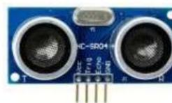
Gambar 2.4. Sensor Ultrasonik
